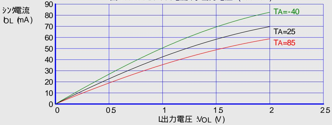
図 184. I/Oピンシフト電流 対 出力電圧 (VCC=2.7V)
