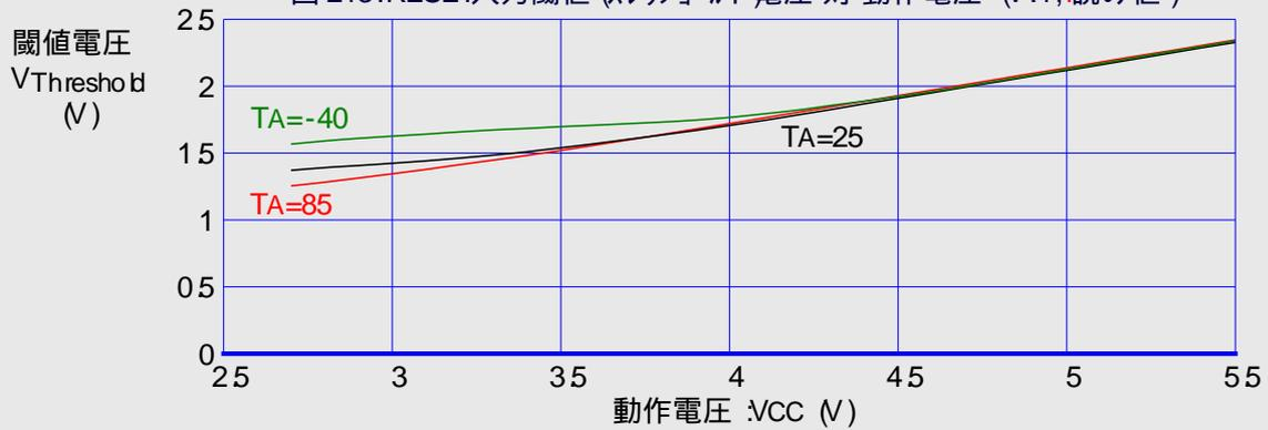
図 214. RESET入力閾値 (スレッショルド電圧 対 動作電圧 (VL, 0読み値))
