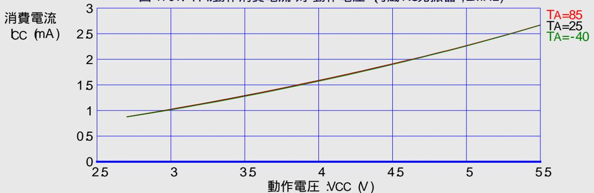
図 171.アイドル動作消費電流 対 動作電圧 (内蔵RC発振器, 4MHz)
