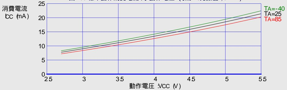
図 166 標準動作消費電流 対 動作電圧 (32kHz外部発振器)
