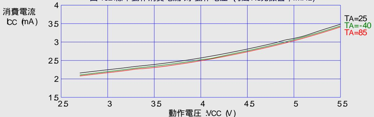
図 163 標準動作消費電流 対 動作電圧 (内蔵RC発振器, 2MHz)
