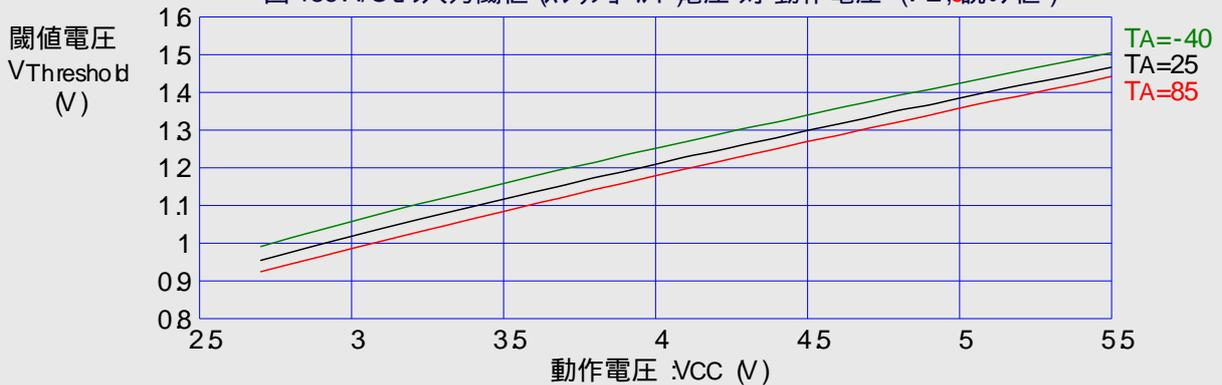
図 187. I/Oピン入力ヒステリシス電圧 対 動作電圧
