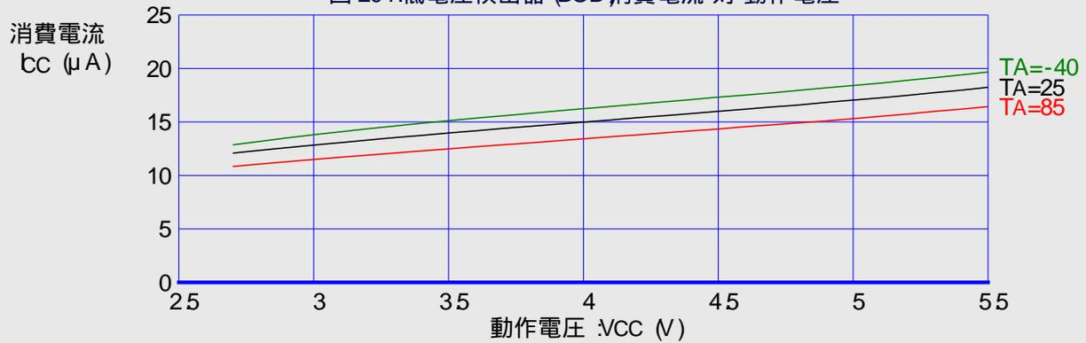
図 205.A/D変換器消費電流 対 動作電圧 変換クロック=50kHz)
