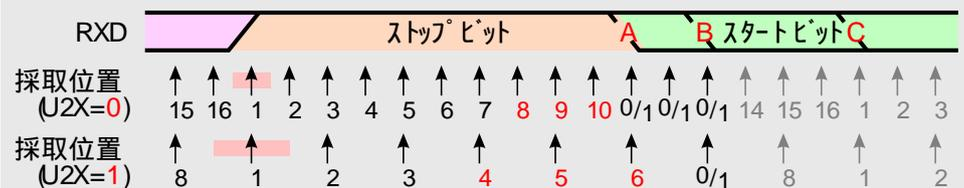
フレーム内の他のビットに対して行われるのと同じ多数決がストップビットにも行われます。ストップビットが論理0値を持つと記録されると、**フレームング エラー (FE)フラグ**がセット(1)されます。
