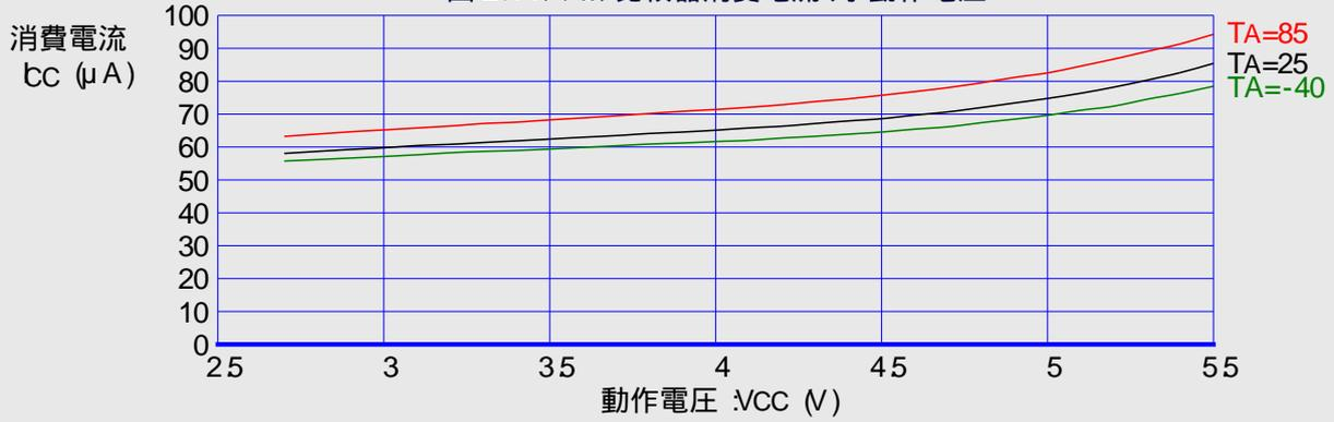
図 208. プログラミング電流 対 動作電圧
