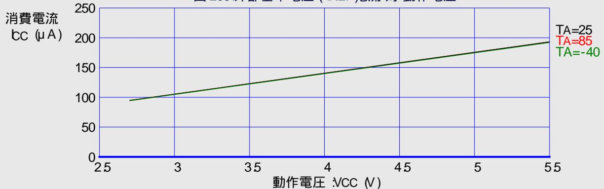
図 207. アナログ比較器消費電流 対 動作電圧
