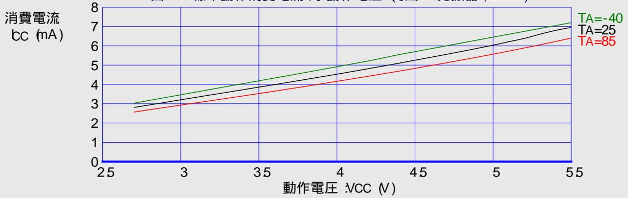
図 164 標準動作消費電流 対 動作電圧 (内蔵RC発振器, 4MHz)
