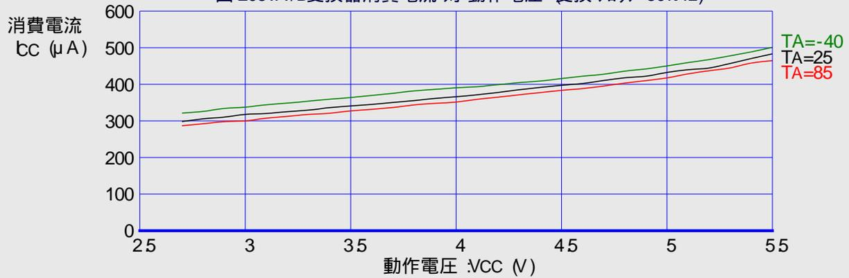
図 206.外部基準電圧 (AREF)電流 対 動作電圧
