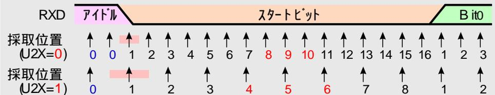
クロック補正論理回路がRXD信号線でHigh(アイドル)からLow(スタートビット)の遷移を検出すると、スタートビット検出手順が開始されます。図で示されるように採取1は最初のLow採取を意味します。その後クロック補正回路は有効なスタートビットが受信されるかを定めるため、標準動作に対して採取8,9,10、倍速動作に対して採取4,5,6の赤数字 **訳注** 原文は箱枠内)で示された採取番号を使用します。これら3回の2回以上の採取が論理Highレベルを持つ場合(多数決)このスタートビットはスパイクノイズとして捨てられ、受信部は次のHighからLow遷移を探し始めます。けれどもも有効なスタートビットが検出されると、クロック補正論理回路は同期化され、データ補正が始められます。この同期化手順は各スタートビット毎に繰り返されます。
