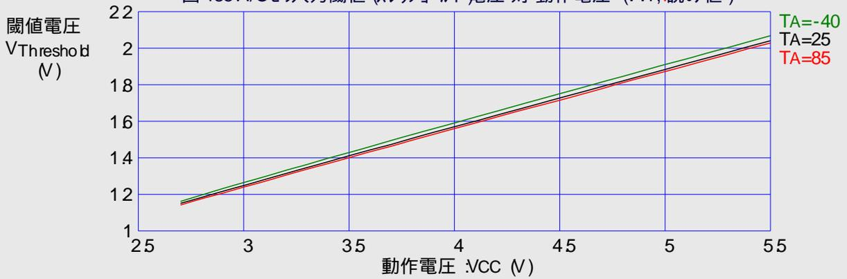
図 186. I/Oピン入力閾値 (スレッショルド電圧 対 動作電圧 (VL, 0読み値))
