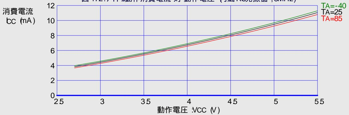
図 173.アイドル動作消費電流 対 動作電圧 (32kHz外部発振器)
