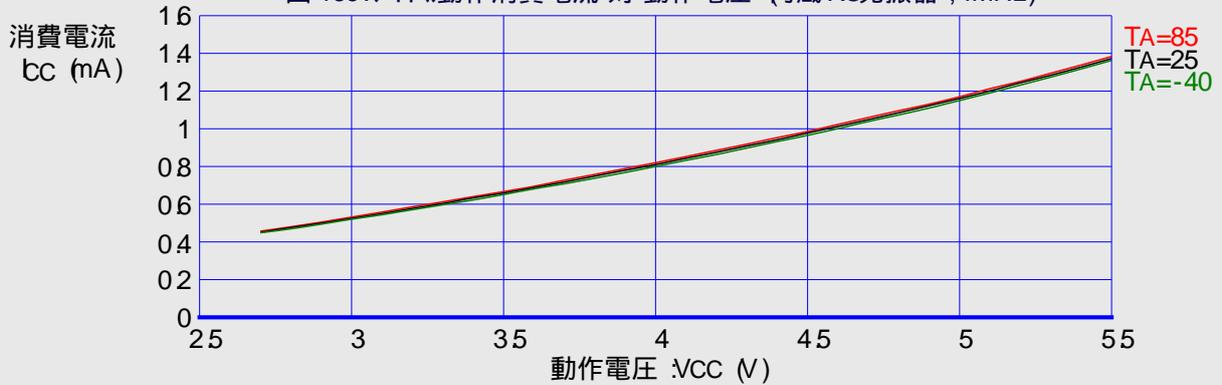
図 170. アイドル動作消費電流 対 動作電圧 (内蔵RC発振器, 2MHz)
