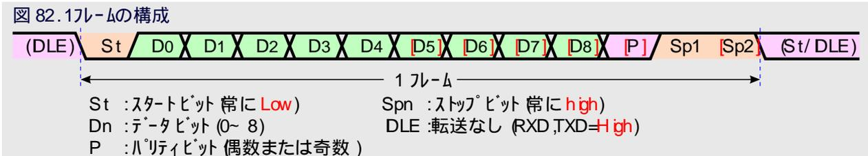
USARTIにより使用されるフレーム形式は **USART制御 /ステータスレジスタBとC (UCSRB, UCSRC)** でデータ長選択 (UCSZ2~ 0)ビット、パリティ選択 (UPM1, 0)ビット、ストップビット選択 (USBS)ビットにより設定されます。受信部と送信部は同じ設定を使用します。これらのどのビットの設定変更も、送受信部両方に対して進行中の通信を不正とすることに注意してください。
