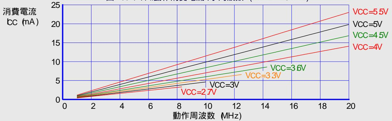
図 169. アイドル動作消費電流 対 動作電圧 (内蔵RC発振器, 1MHz)
