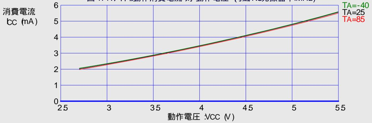
図 172.アイドル動作消費電流 対 動作電圧 (内蔵RC発振器, 8MHz)
