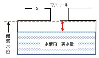
水槽は、円筒形の途中から 直方体になっている。 円筒形の最下部から水面まで の距離( → )を目測する。 必要に応じ棒などの簡易測定具 を使用してください
