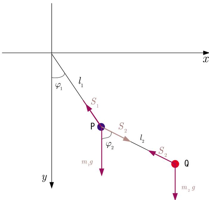
2本の針金が鉛直方向に対してなす角をそれぞれ  $\varphi_1, \varphi_2$  とし、針金の張力を  $S_1, S_2$  とすると、P, Qの水平方向、鉛直方向の運動方程式は（ $\ddot{x}_1$  などの記号は  $x_1$  の時間の2階微分  $\ddot{x}_1 = \frac{d^2x_1}{dt^2}$  を意味する）
