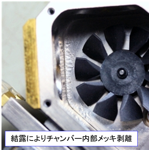
結露によりチャンバー内部白濁
