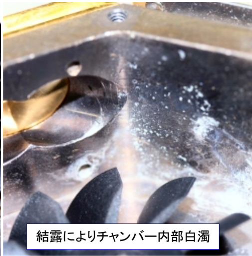
結露によりチャンバー内部メッキ剥離
