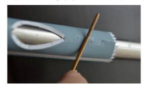
胴体後部を丸めて接着し、下部に切り込みを入れて接着します。
