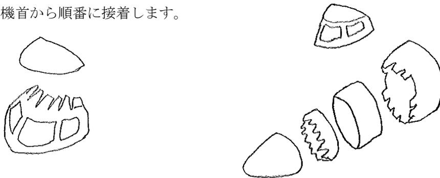
完成した機首部を胴体に接着する時は、接着剤を付けすぎると修正が出来なくなりますので、機首部の根本に少し付けて、位置を合わせて差し込むようにしてください。
