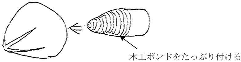
機首部の隙間部分を、タケヒゴ等で転がすように押し付け形を整えます。木工ボンドを使用するのは、木工ボンドは水分があり、紙が伸びやすくなるので、形を整えるのに都合が良いからです。
