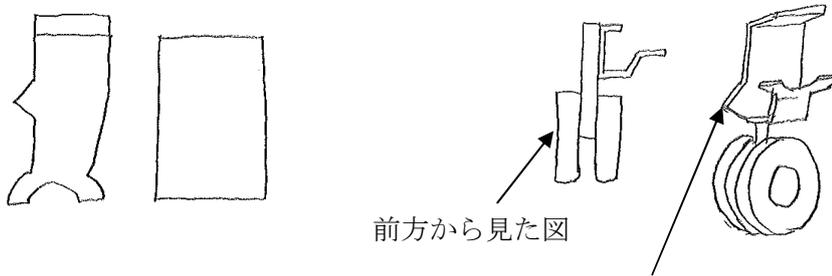
主翼に接着する時は、とがっている部分がある方を尾部側にする
