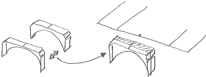
補強板を貼り合わせ、主翼取り付け部の底板に貼り付けます。このとき、補強板の片方だけに貼り付けます。(斜線部分)
