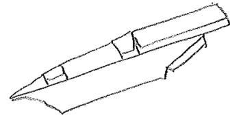
エンジンナセルを取り付け部に接着し、主翼の指定位置（線の描いてあるところ）に接着します。
