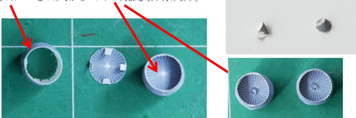
後部のカバーを加工し中央部に接着します。
