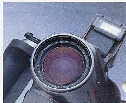
CAMEDIA C-1000Lのレンズは35mmカメラ換算時で50~150mmとやや望遠よりシフトしている
