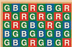
●図3 CCDの構造の概念図。周囲の異なる色の画素の情報を参考に、画像全体を組み上げる
