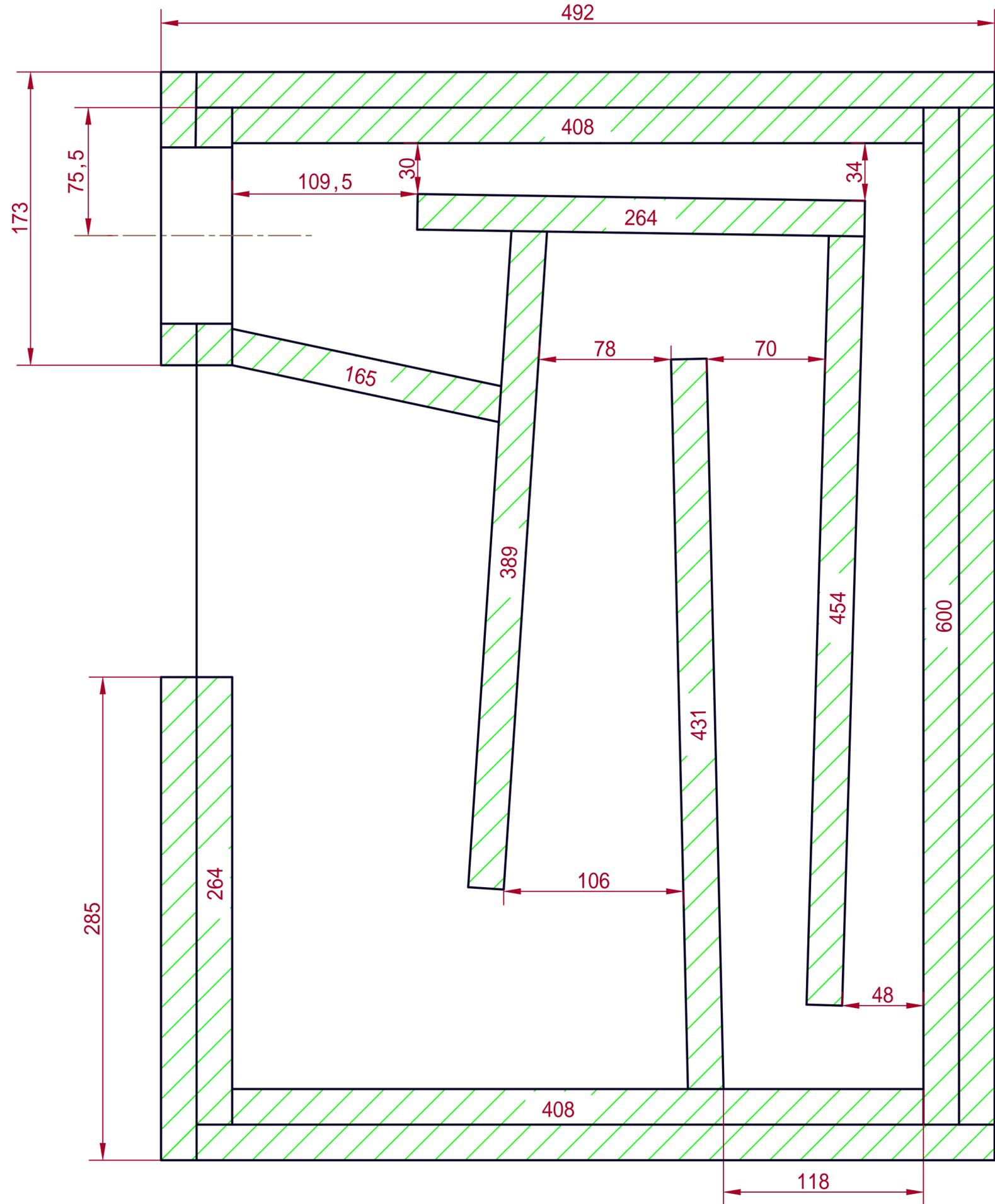
自作スピーカー製作バックロードホーン2
