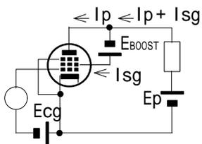
図 3 Esg 一定, Ip+Isg 出力
