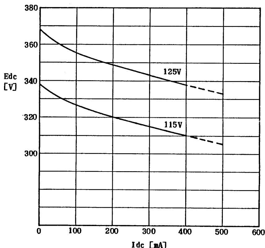
整流用のダイオードは、その最大尖頭逆方向電圧が倍電圧整流時には電源トランスの端子電圧の3倍(ブリッジ整流時には2倍)以上のもので信頼性の高いものをお使い下さい。
