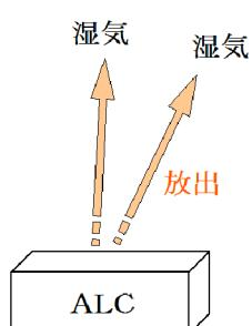
独自に開発した機械を用いてALC37mm板の廃材を粉砕、直径5~20mmにしたものを使い床下に3~5cm敷き詰めることで湿度を調整します。
